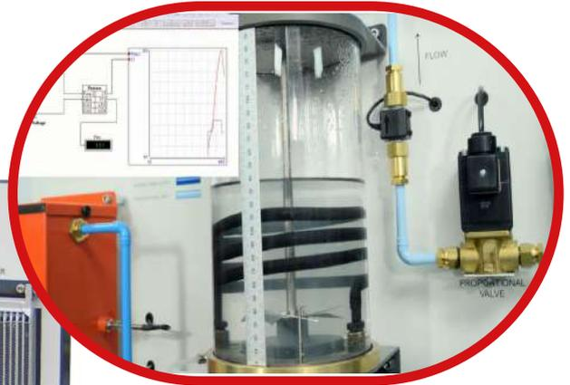
Sistema de ensino para montagem em bancada, permite experimentos de controle de processo em vazão, nível, pressão e temperatura.
