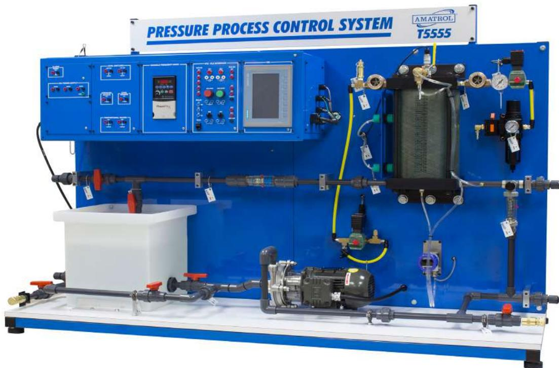
O T5555 é formado por uma estação de trabalho robusta e construída em aço. Utiliza componentes de qualidade industrial organizados de forma que o aluno possa controlar o nível e pressão do fluido no tanque de processos simultaneamente através de uma interface homem máquina (IHM) touchscreen, um controlador programável e um inversor de frequência, que são métodos de controle muito comuns nas indústrias.
