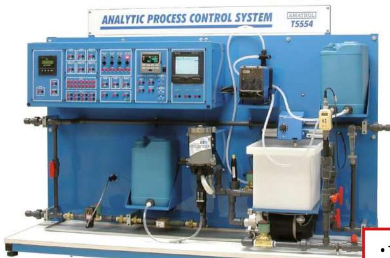
O T5554 é formado por uma estação de trabalho construída em aço industrial, soldada e equipada com componentes de qualidade industrial. Utilizado para o ensino de conceitos de controle analítico em situações industriais.
