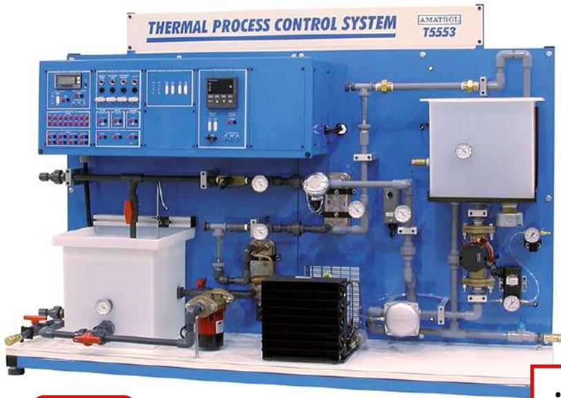
O T5553 é formado por uma estação de trabalho construída em aço, soldada, contendo componentes de qualidade industrial, montados e organizados em dois circuitos de vazão de água, sendo, malha de processo e malha de aquecimento, utilizada para controlar a temperatura da água que flui pela malha de processo.
