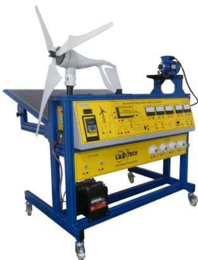
Este sistema permite estudar todos os elementos necessários para a cadeia de conversão de energia no caso da geração de eletricidade a partir de energias renováveis. Para não ficar na dependência das condições climáticas, esta bancada é equipada com uma fonte de alimentação programável que simulará diferentes cenários de produção (solar, eólico). No entanto, pode ser conectado facilmente com fontes reais de produção (painéis solares fixos ou rastreados, turbina eólica).
