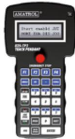
**TEACH PENDANT:** Ferramenta utilizada para movimentar o robô, gravar seus pontos e realizar a simulação.
